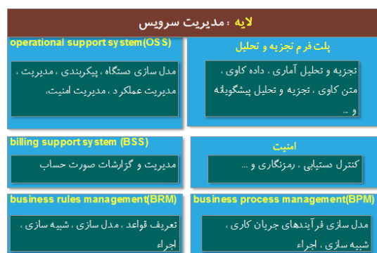
شکل ۲-۱۱: لایه مدیریت سرویس در معماری اینترنت اشیا
